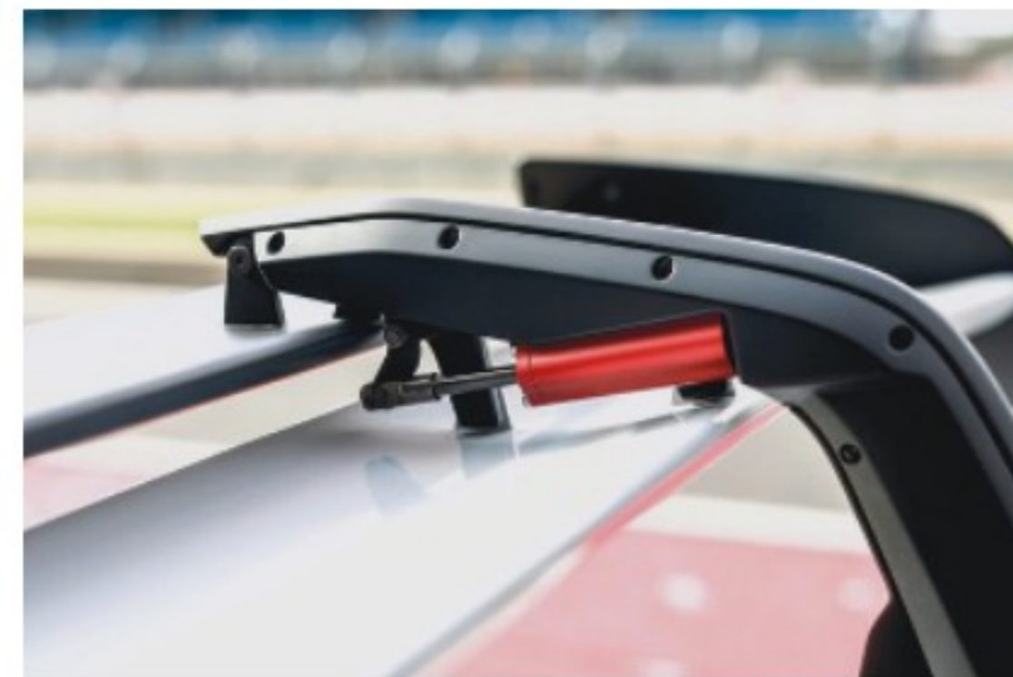
L'aileron arrière possède des vérins qui ajustent la position de la lame supérieure.
