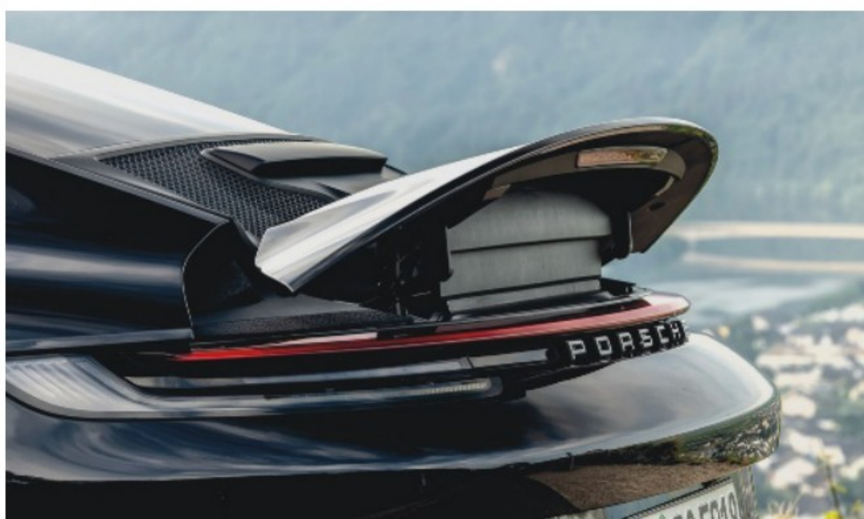
La GT3 Touring a droit à un becquet arrière relevable automatiquement, qui limite la perte d'appui sur l'arrière par rapport à la GT3.
