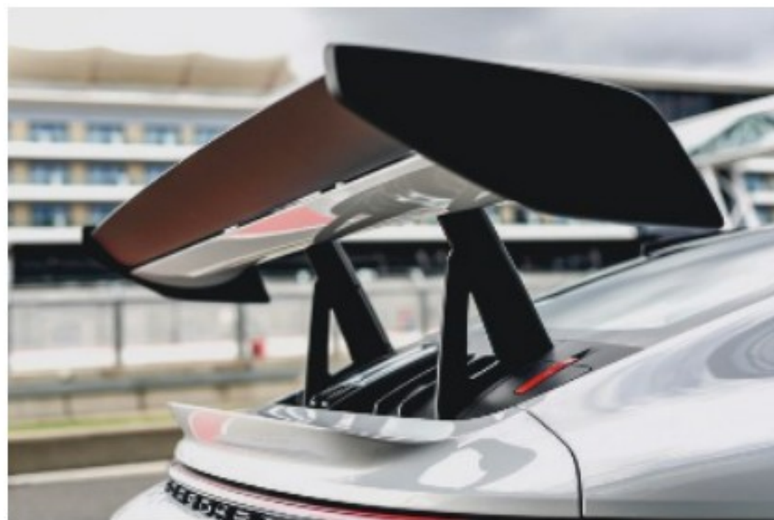
L'aileron arrière possède des vérins qui ajustent la position de la lame supérieure.
