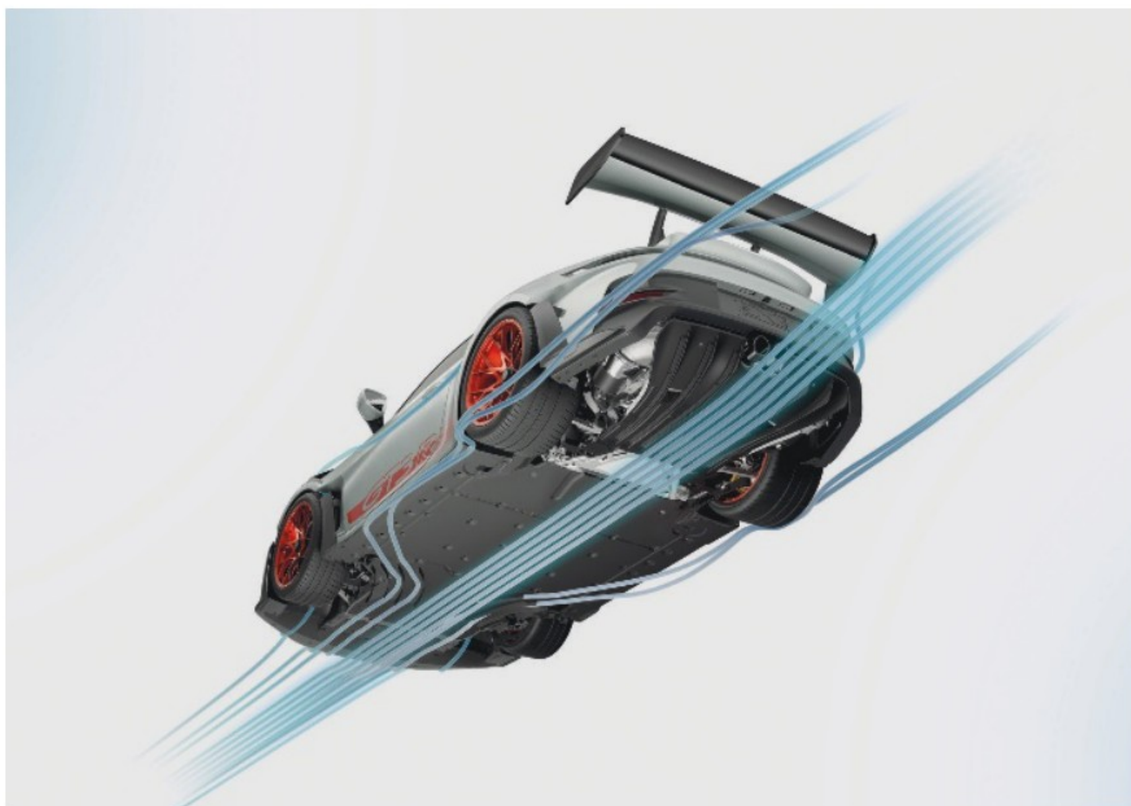
Le carénage sous la voiture fait presque office de fond plat.
