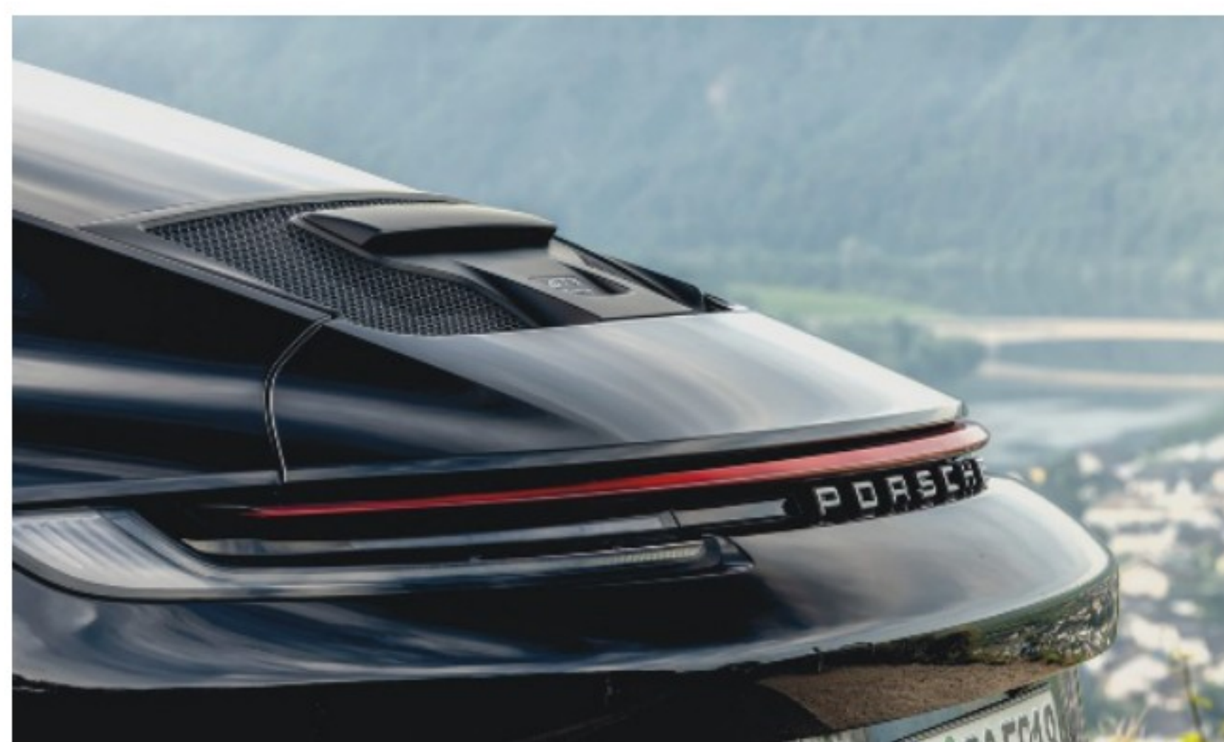
La GT3 Touring a droit à un becquet arrière relevable automatiquement, qui limite la perte d'appui sur l'arrière par rapport à la GT3.
