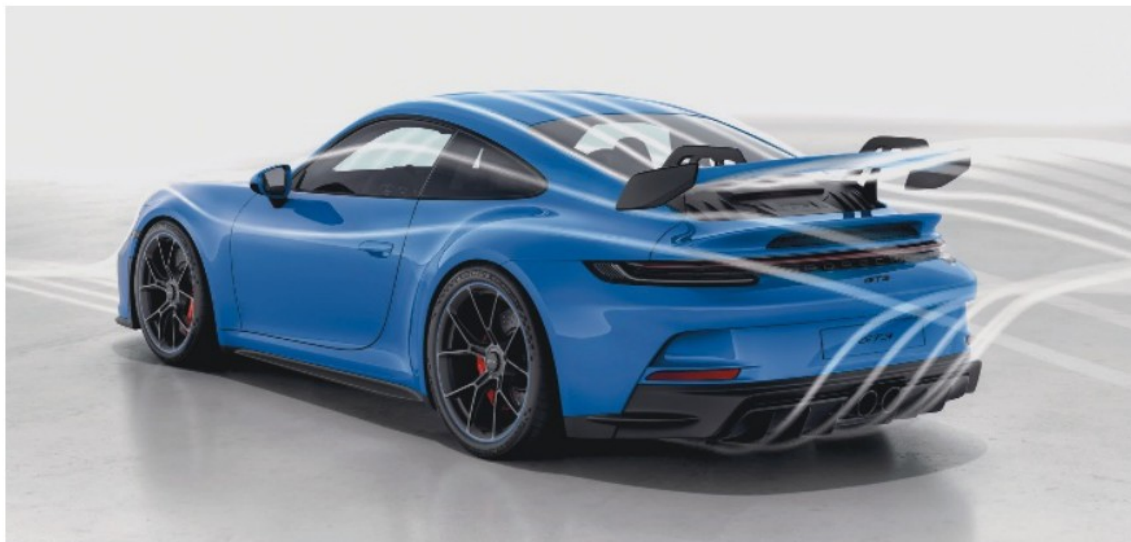
L'aileron arrière en col de cygne est lui aussi emprunté à la compétition, il accélère l'écoulement de l'air sans pénaliser l'appui.
