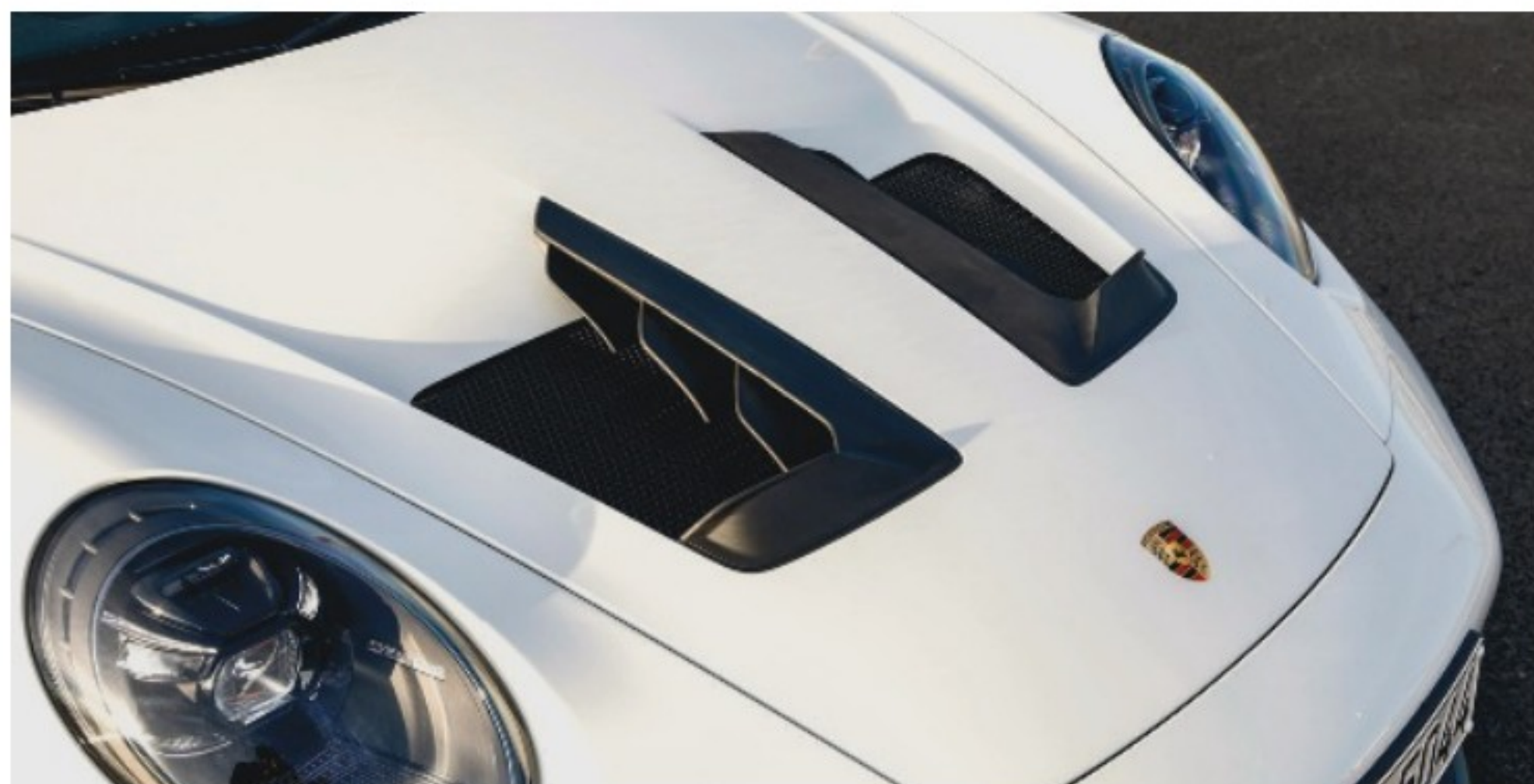
Les flux d'air chaud sont évacués vers les flancs par le biais de ces extracteurs.
