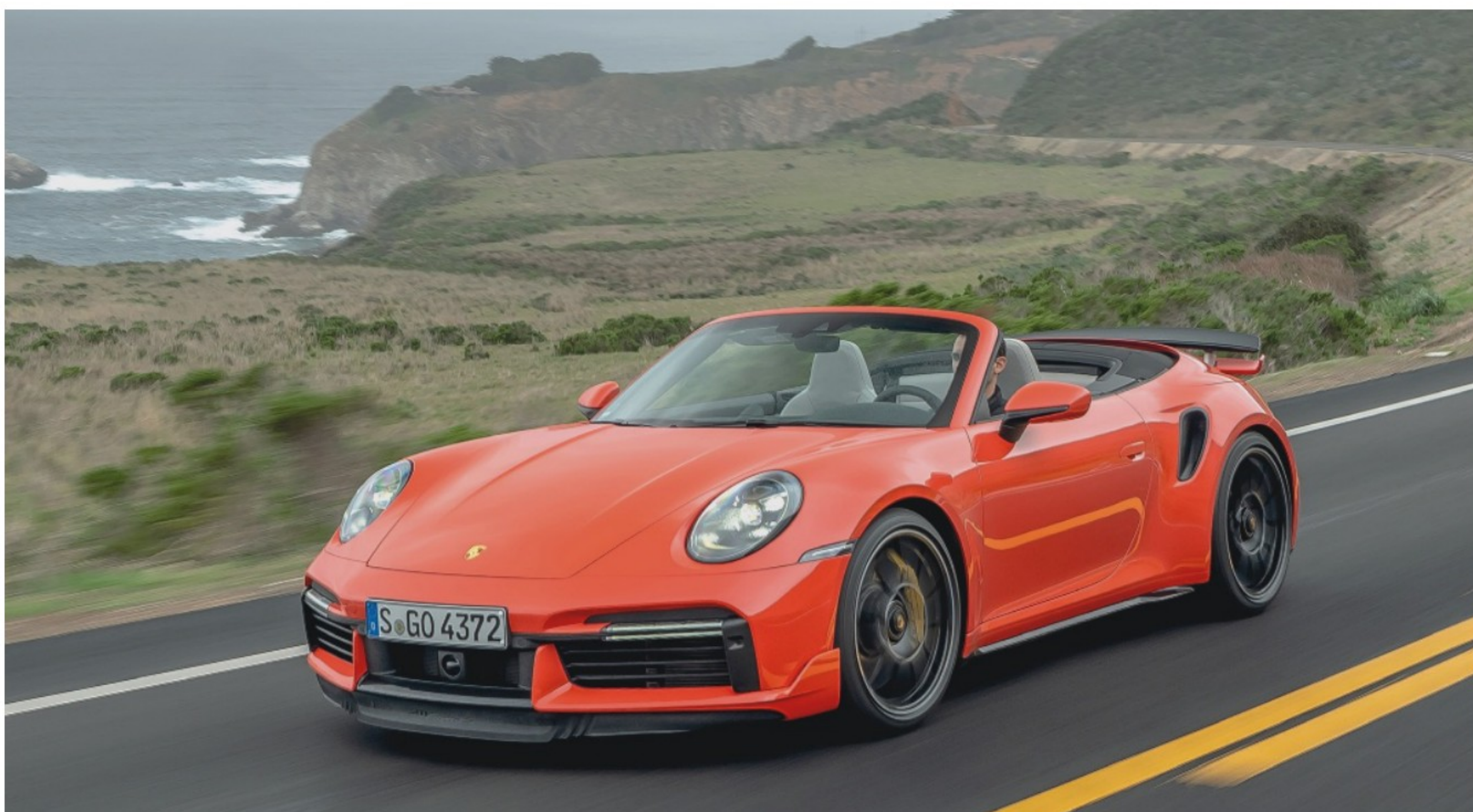
Ce modèle possède l'aérokit Turbo qui se caractérise à l'avant par deux lèvres de bas de caisse plus marquées, et les jupes latérales sur les flancs.
