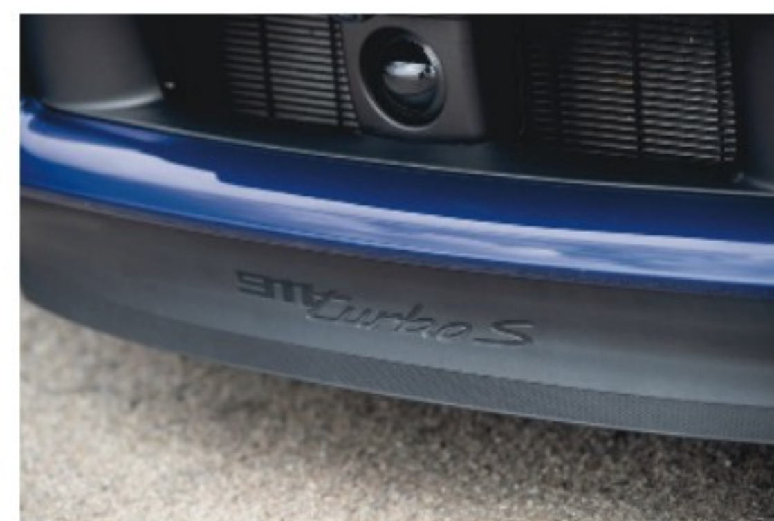
La lèvre avant se déploie en fonction de la vitesse.
