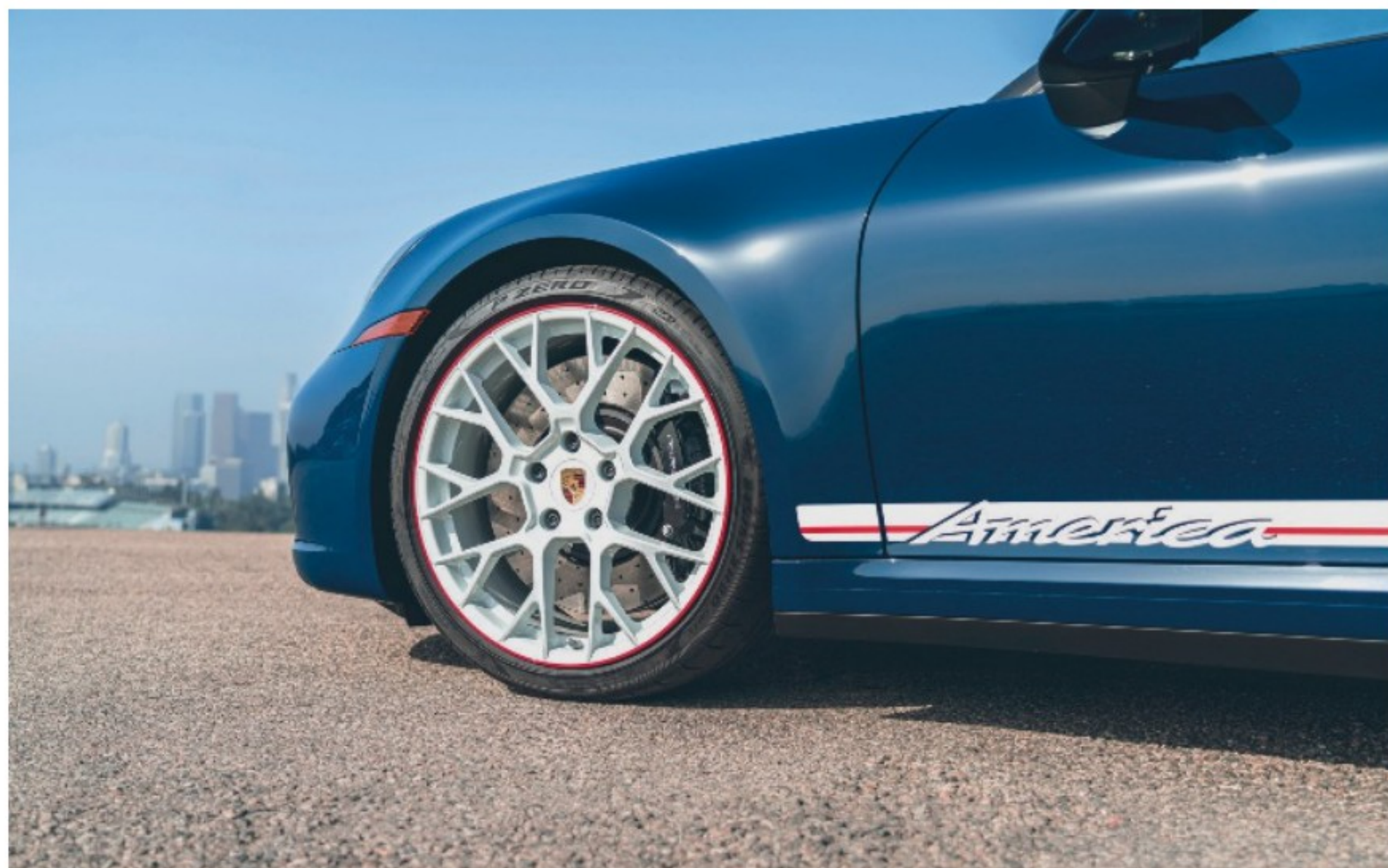
L'America Edition a des jantes à 5 écrous. Une GTS normale a des écrous centraux.
