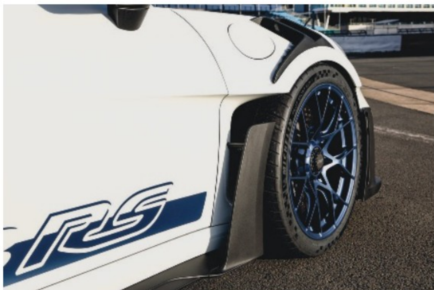
Les dérives placées derrière les roues avant servent à accélérer l'écoulement des flux d'air.
